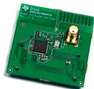
**Kleiner Chip, große Reichweite: Der CC1310 soll Sensoren mit dem Internet der Dinge über bis zu 20 km verbinden.**
