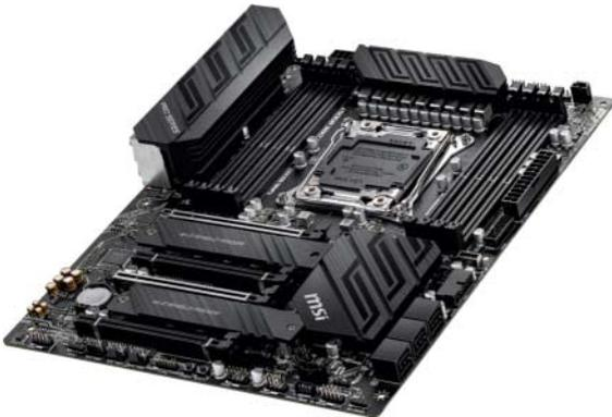
Mit dem LGA2066-Board MSI X299 Pro lässt sich ein High-End-PC mit 18 CPU-Kernen und 256 GByte Arbeitsspeicher bauen.
